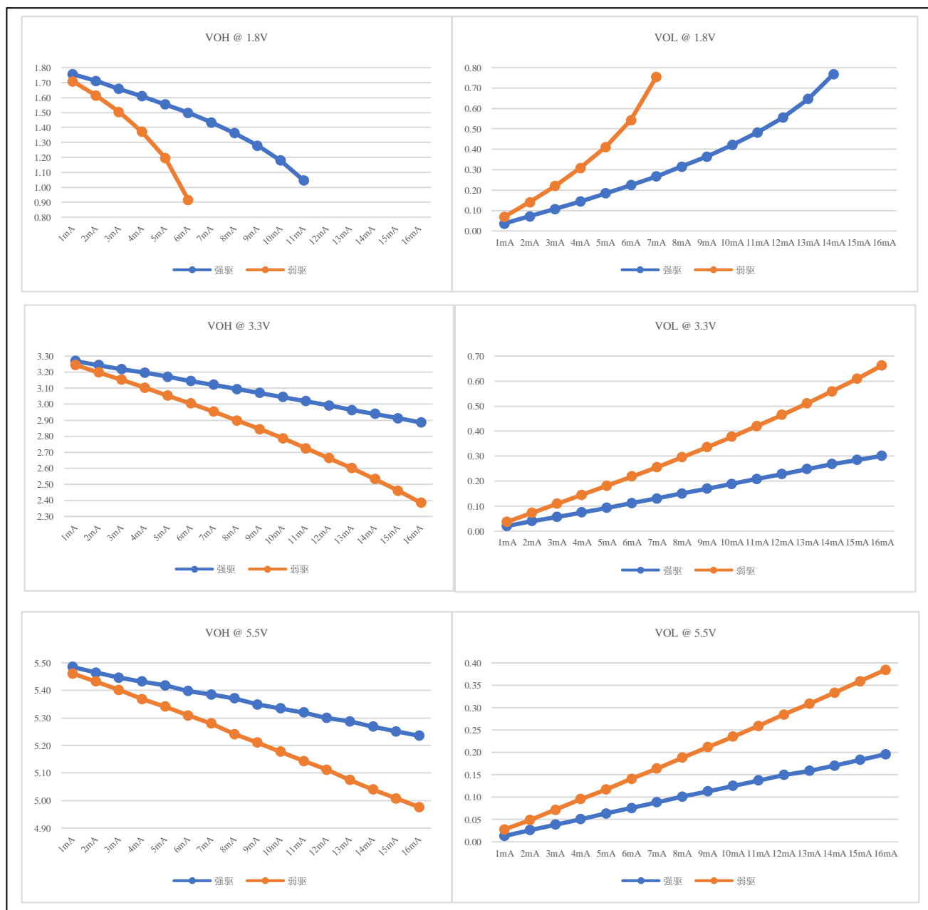
图 7-2 输出端口 VOH/VOL 实测曲线
