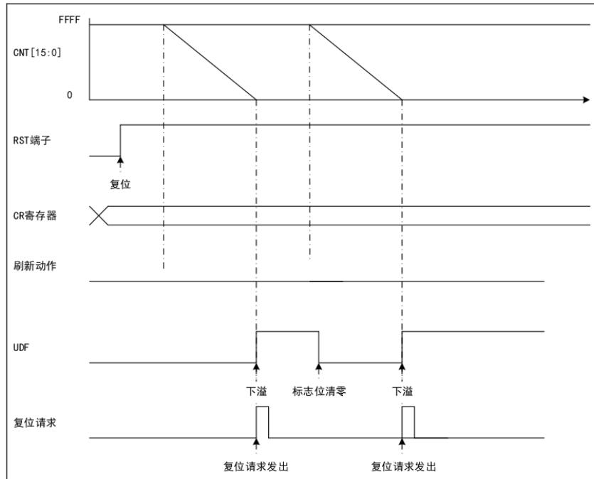
SWDT\_RR 寄存器中先写 0x0123、再写 0x3210 完成一次刷新动作，SWDT 的计数器就重新开始计数；刷新错误标志位和计数下溢标志位在复位请求和中断请求的情况下都会保持。
